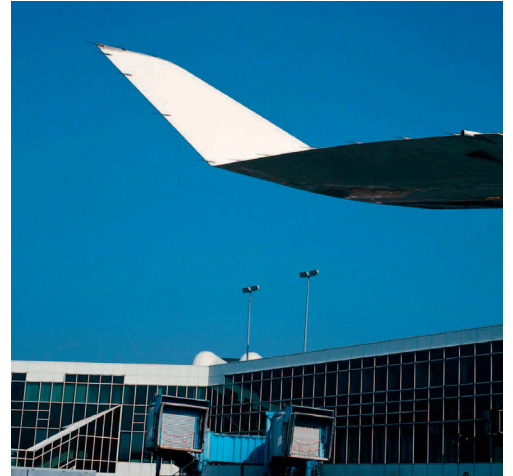
Ein Winglet an der Spitze einer Tragfläche
